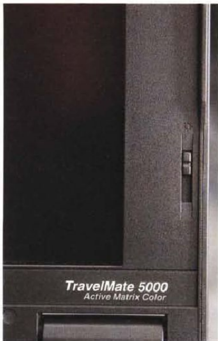
A fianco particolare dello slider della luminosità. Le batterie riservano una vera novità: una piccola scala a led che indica anche con la batteria estratta la quantità di carica.
